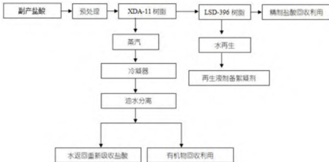
图2.4-9 副产盐酸精制工艺流程图
