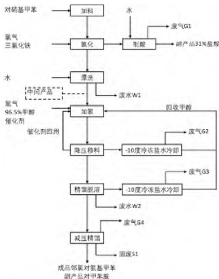
图2.4-8 氯氢产品生产工艺流程及产污环节图
